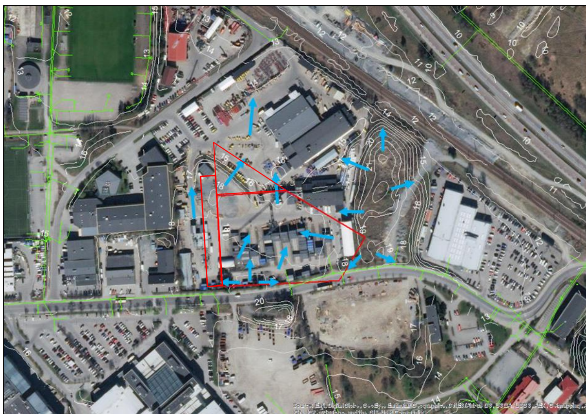
Figur 3-6. Flödesriktningen inom markanvisningsområdet går enligt topografin med befintlig markanvändning i huvudsak i nordlig riktning. Huset i den östra delen av området är redan rivet.
